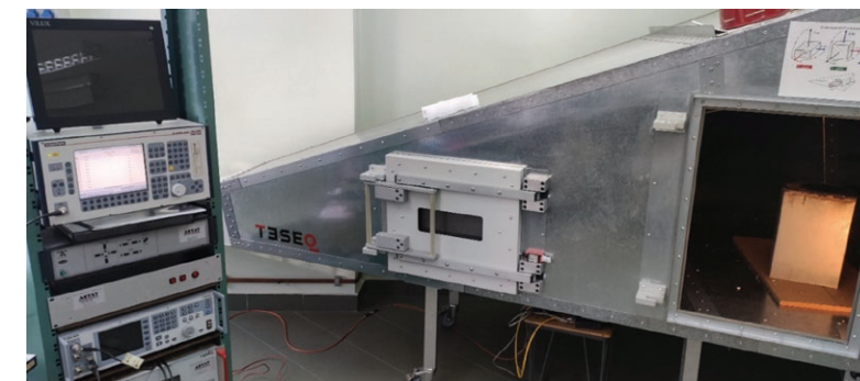
Rys. 2. Badania poziomu odporności na promieniowanie elektromagnetyczne pochodzące z zewnętrznych źródeł prototypowej warstwy kompozytowej.
