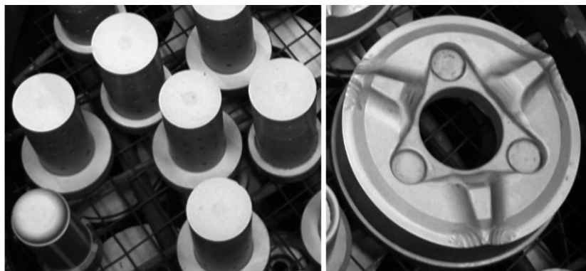
Przykład azotowanych narzędzi do przeróbki plastycznej (źródło: Seco/Warwick S.A.).
