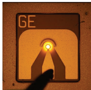
Zdjęcie lasera poniżej progu emisji laserowej (z lewej) i powyżej progu (z prawej).
