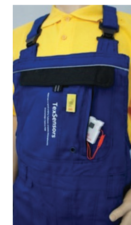
Prototyp odzieży roboczej z wymiennym sensorem i układem elektronicznym.
