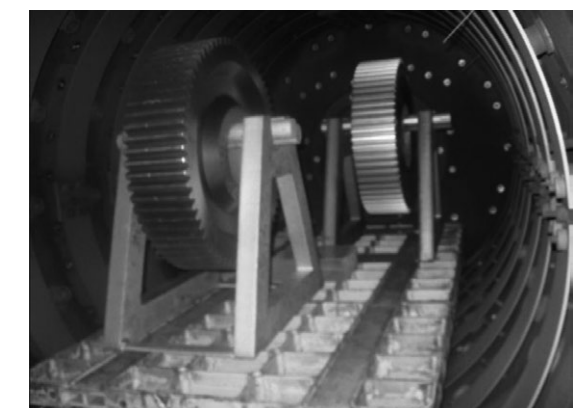
Elementy uzębione po nawęglaniu LPC i hartowaniu (źródło: Seco/Warwick S.A.)
